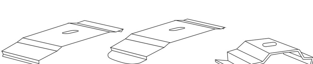
Após a instalação dos suportes, encaixe a parte de trás do trilho no suporte empurrando a parte dianteira girado para cima até seu encaixe no suporte, após ouvir o "click", cheque o nível e o alinhamento da peça.
