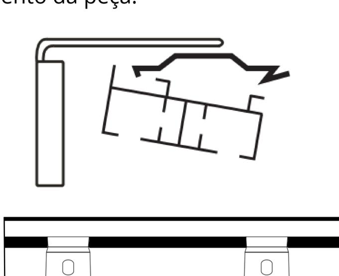
Após a instalação dos suportes, abra as travas e encaixe o trilho no suporte e cheque se está nivelado e alinhado.
